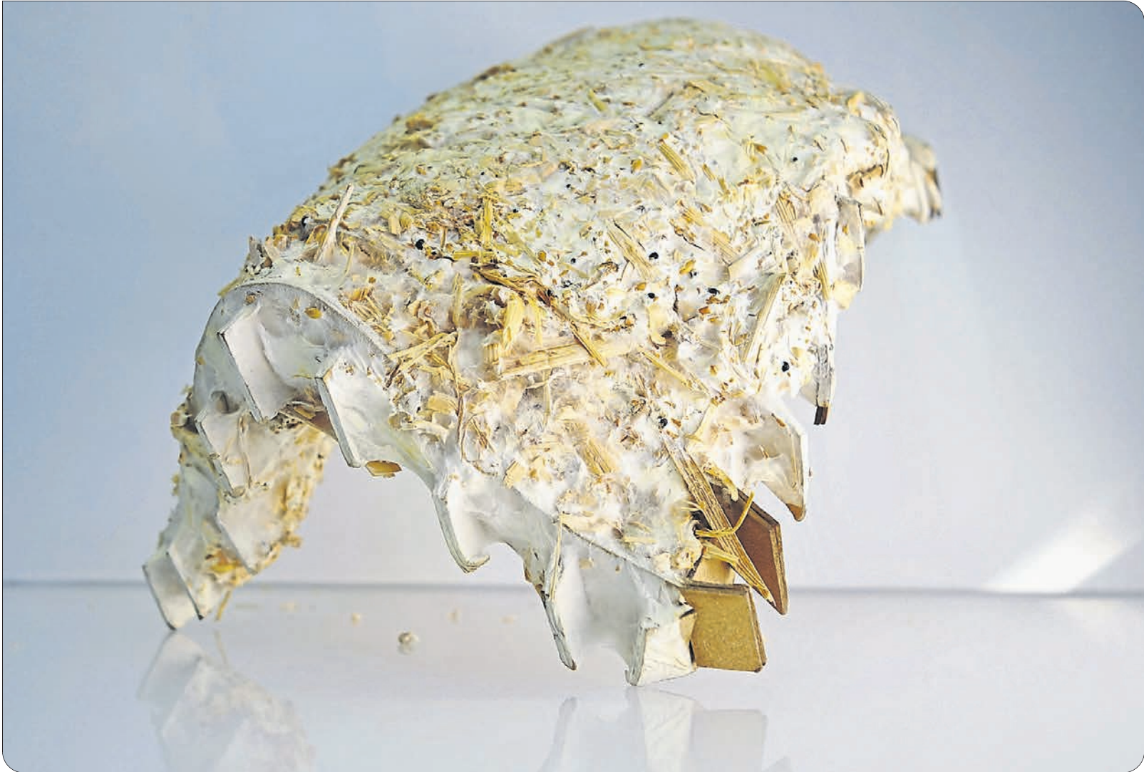
Ein Pilzmyzel überwuchert eine Pappendeckelstruktur (mit Holzspänen als Pilz-Futter) und bildet dadurch einen Bauteil mit der gewünschten Form. [GrAB-Team/Barbara Imhof]
